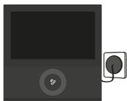
Brancher l'alimentation du moniteur et le placer à proximité du routeur Wi-Fi. Le téléphone doit être connecté au même réseau Wi-Fi que le moniteur et la localisation doit être activée.
