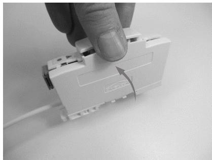
Remettre le volet en place en veillant à la bonne mise en place de ses accroches.
