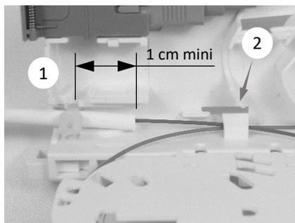
Fixer le câble avec le collier de serrage, puis passer le module sous la languette.
