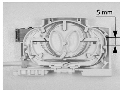
Introduire le module dans la cassette et réaliser les soudures selon les règles de l'art.
