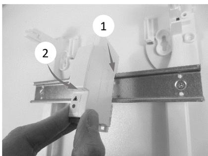
Clipper le DTIO sur le rail DIN.
