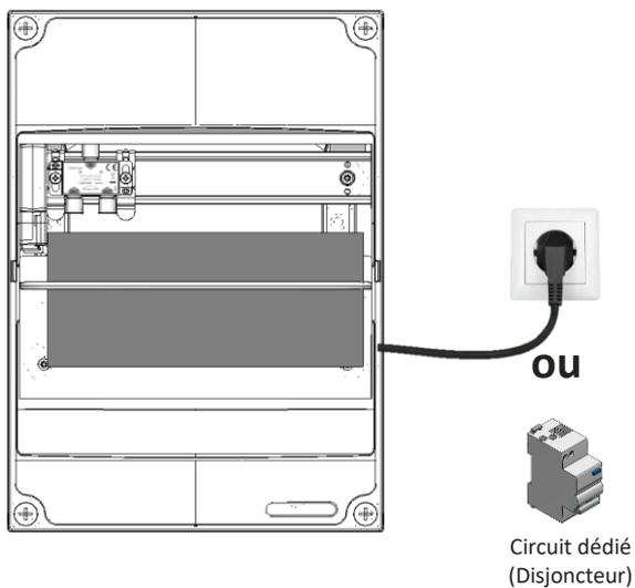
Raccorder le bloc prise sur une prise électrique à proximité du coffret ou effectuer un raccordement conforme aux règles d'installation de la norme NF C15-100.
