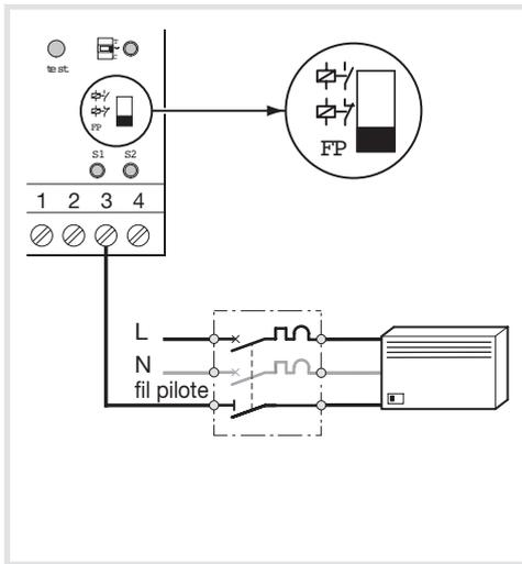
Sortie paramétrée en contacteur à ouverture
