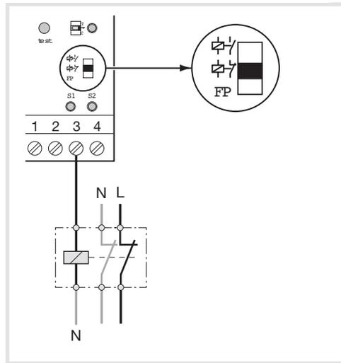
Sortie paramétrée en contacteur à fermeture
