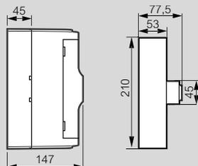
Compteurs/disjoncteurs montés sur platine : encombrement maxi disponible sous habillage
