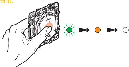
**2** Le voyant du micromodule fourni dans le kit s'éteint. Votre kit de ventilation est fonctionnel : la commande sans fils contrôle désormais le groupe de ventilation EasyHOME Auto with Netatmo.
