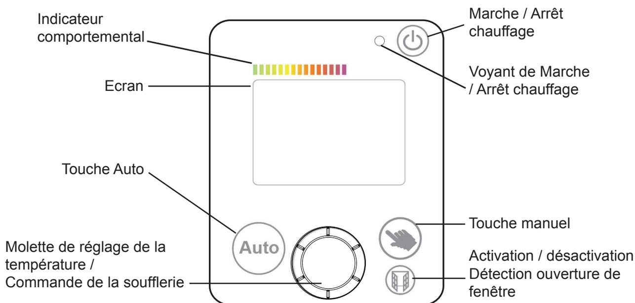
Bouton ON / OFF : Interrupteur Marche/Arrêt (pour l'arrêt complet de l'appareil, notamment en été)
