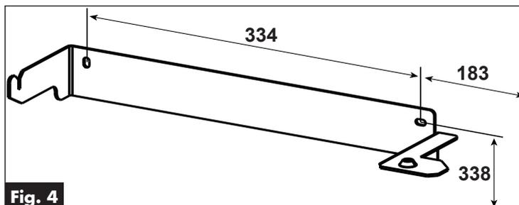
Posez l'appareil sur le support mural et appuyez-le contre le mur, tracez l'emplacement de la patte murale, retirez l'appareil.
