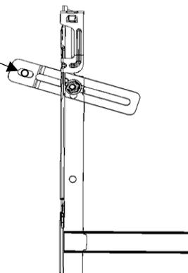
❸ Sur un support plat, pré-assembler les 4 brides sur le support mural de l'appareil à l'aide des 4 écrous.
