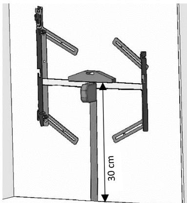
❹ Présenter le support mural avec les brides sur les trous de fixation du mur puis fixer les brides à l'aide des vis existantes. Pensez à régler le niveau et la hauteur du support mural comme indiqué ci-contre.
