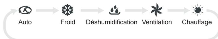
Si le mode Auto est sélectionné, le climatiseur opérera automatiquement selon les paramètres du fabricant. En mode Auto, la température ne peut être ajustée et ne s'affichera pas. Appuyez sur le bouton Fan pour régler la ventilation. Appuyez sur le bouton SWING pour ajuster l'angle de ventilation.
