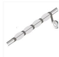
11 - CALORIFUGER LES LIAISONS (ADHESIF NON FOURNI)
