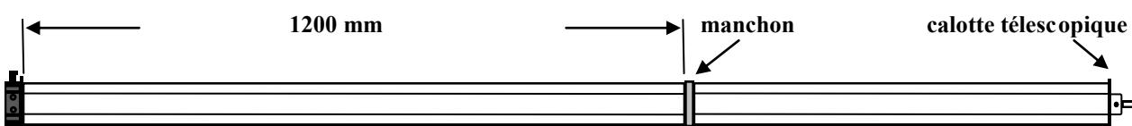
**03. Si une seule longueur de tube suffit, le couper à la longueur nécessaire.** — Couper le tube avec précaution sur la base de la longueur du tube déterminée précédemment (voir PHASE 3), sans déformer le profil à l'extrémité.
