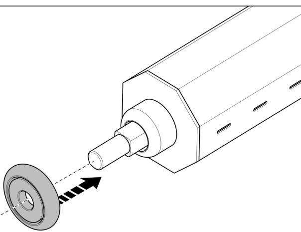
**08.** Introduire la calotte télescopique dans le tube (fig. 13). Durant l'opération aligner la rainure (d) présente sur la calotte avec la saillie (c) présent à l'intérieur du tube d'enroulement.
