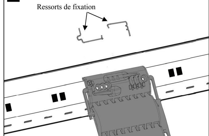
*S'assurer de la parfaite fixation des verrous automatiques de sécurité sur le tube en effectuant une traction sur ceux-ci.*
