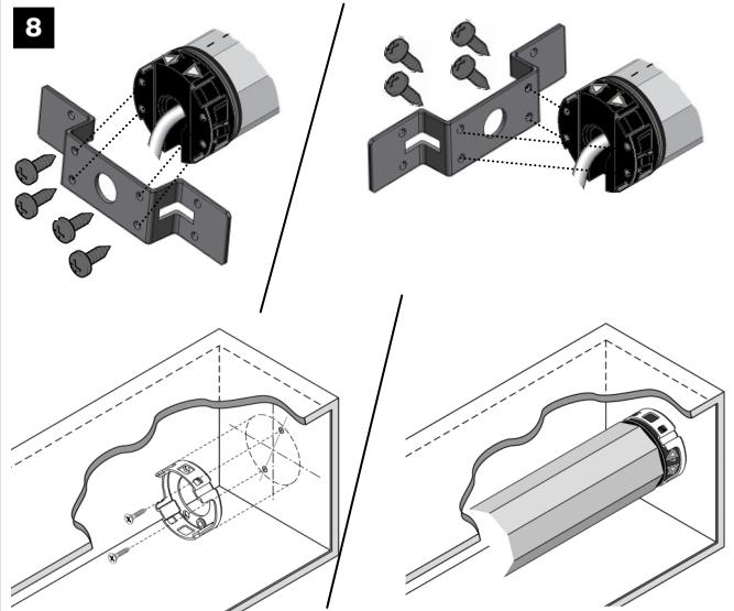
**04. Fixation de la tête moteur.** - Visser le support **d** avec les vis fournies en le centrant sur la tête moteur. Fixer l'ensemble sur le flanc du coffre (**fig. 8**). Si le coffre du volet est équipé de flasques fixes, il est possible qu'il soit nécessaire d'y fixer le support en enfilant le tube au travers (**fig. 9**). Il est aussi possible de fixer la tête moteur directement sur une patte de fixation présente dans le coffre.
