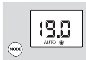
Nota : L'appui 3 secondes sur la touche **MODE** permet d'alterner entre la programmation «AUTO» et la programmation «PREDEFINIE»
