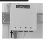
Pour faire les mesures de contrôle ou pour raccorder un appareil au réseau optique, brancher un cordon optique sur une sortie du DTIo.
