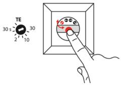
Une pression sur le bouton-poussoir et une rotation du potentiomètre «TIME» simultanées permettent de régler la luminosité de la lumière de nuit de 0 à 100 %. La durée de temporisation est réglable par paliers.
