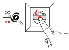
Une pression sur le bouton-poussoir et une rotation du potentiomètre «LED» simultanées permettent de régler la luminosité de la lumière de nuit de 0 à 100 %.
