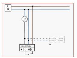
En cas d'induction sur le réseau (lampes fluorescentes, contacteurs, etc.) un filtre RC peut s'avérer utile.
