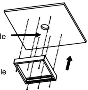
3/ Déposer l'un des deux côtés non fixés au support, procéder au raccordement de la dalle LED au réseau électrique, faire glisser la dalle LED dans le cadre, remonter le côté puis rétablir l'alimentation électrique
