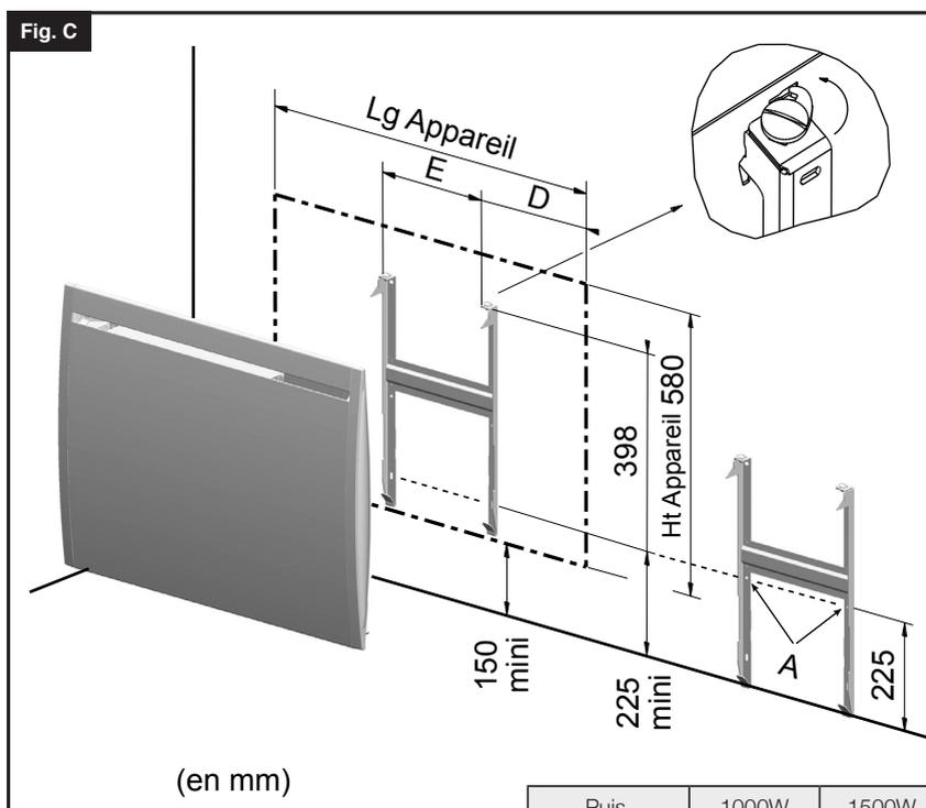
*Conseil* : Pour faciliter l'obtention de la cote minimale de 150mm (bas de l'appareil par rapport au sol), il suffit de placer le dossier contre le mur, pattes inférieures posées au sol, pour avoir grâce aux repères de perçage (Rep. A Fig. C), les deux fixations inférieures du dossier.
