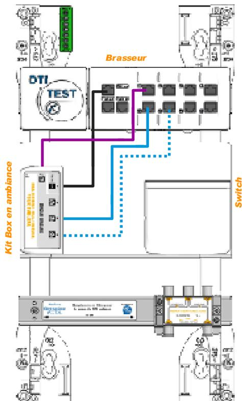
Dans le coffret, avec un **cordon RJ45/RJ45 30 cm**, connectez la prise **Tél @** de la multiprise multimédia sur le **départ RJ45** du brasseur correspondant à la prise murale sur laquelle sera branché un téléphone (qui fonctionnera avec la ligne téléphonique par internet).
