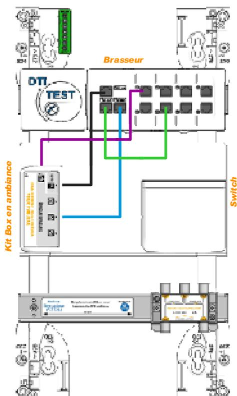
Dans le coffret, avec un **cordon RJ45/RJ45 30 cm**, connecter la prise **Tél @** de la multiprise multimédia sur la prise **Tel@ in** du brasseur. Dans cette configuration, toutes les prises murales RJ45 reçoivent automatiquement le téléphone issu de la Box.
