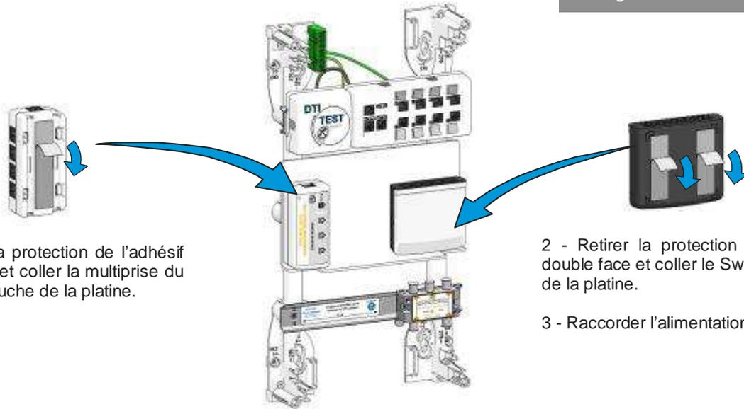
1 - Retirer la protection de l'adhésif double face et coller la multiprise du tableau à gauche de la platine.
