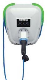
Chargeur VersiCharge CEI 1PHx32 A mode de charge 3, CEI 61851 230 V 50/60 Hz câble de charge 7 m Accouplement type 2 CEI 62196 Indice de protection IP56 Marche/arrêt/temporisation 6 mA RCD
