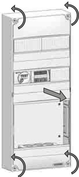
1 - Desserrer les 4 vis de fermeture et retirer le capot.
