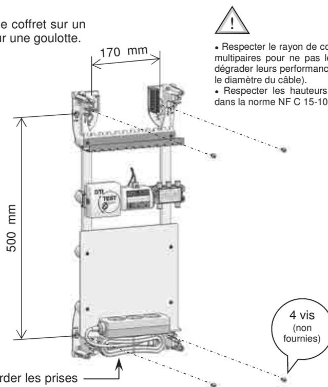
3 - Raccorder les prises du coffret à une prise de puissance.
